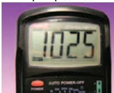
Конденсатор заряжается (Сопротивление растёт)
